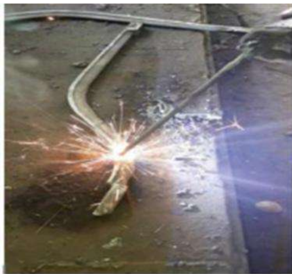
3-rasm. Kolosniklarni payvandlab qayta tiklash
